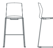
960-STL30-WA Celebrate Bar height stool H44.75 W21 D20.5 SEAT H30 W17 D17.75
